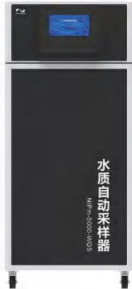
NIPm-5000-WQS水质自动采样器是一款采用嵌入式控制技术，可根据不同应用场景，启动蠕动泵将水样采集到指定的留样瓶中并密封，从而完成水样的自动留存、自动密封，可根据现场需求扩展固定剂自动添加功能，符合：HJ915-2017《地表水自动监测技术规范（试行）》。HJ/T372-2007《水质自动采样器技术要求及检测方法》。HJ493-2009水质 样品的保存和管理技术规定。
