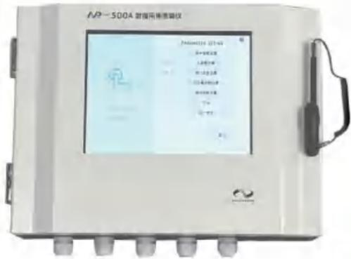
NIPm-500A数据采集传输仪，是新一代环境监测、污染源监控专用数据采集器，按照工业级标准设计，针对环境监测的各种要求做了专门的优化，配备了丰富齐全的通信接口，支持局域网、以太网、4G有线和无线通信方式，满足不同现场环境下对远程通信的要求。
