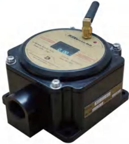
FlexNode是一套灵活可配置的多参数无线传感器套件一个FlexNode节点可同时接入多个不同种类传感探头适用于设备运行(电机、泵阀等)监控系统、管网地井监控系统、工厂用电监控系统、能源数据采集及监控系统智能楼宇监控系统、环境监测系统等不同应用场景的需求FlexNode支持NB-IoT、LoRa等多种无线物联网传输网络FlexNode防护等级为IP67防爆标志为Ex ia IIC T4,使用环境温度为-40~60,可直接用在绝大多数特殊环境
