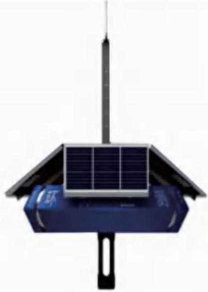
NIPm-5001 型水质在线监测浮标仪主要用于地表水水质在线监测。该系统由多参数（多合一）水质传感器（温度、pH、DO、电导、浊度等）、浮标体、太阳能板、数采仪（含 GPRS、GPS）、天线、夜间警示灯等组成。系统整体采用集成式一体化设计，体积小巧轻便，运输安装便利，适合于大规模部署，可自动检测电源和各单机工作的状态跟踪浮标位置，有故障时自动报警。
